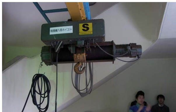
写真 3. 水槽を吊り上げ巨大水槽に魚を移す機械. (写真2の上部の黄色のレールと写真3の黄色のレールは繋がっている.)
