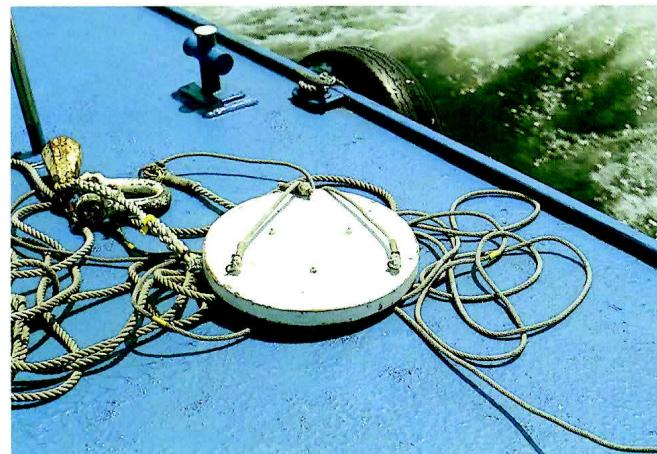
透明度板：セッキー円板とも呼び、直径30cmの白色の板におもりとロープを付けたもの。水中に沈めて、見えなくなった深さを透明度という。富栄養湖では、透明度が1mにも満たないことがあり、一方、きれいな湖として有名な摩周湖(貧栄養湖)では、41.6mという記録がある。
