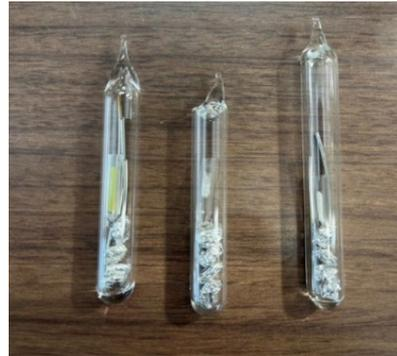
Fig. 2 ガラス封管 (PP、PE、PS)
