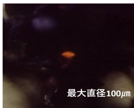
屋上に設置した水から採取できた ポリスチレン（发泡スチロール）
